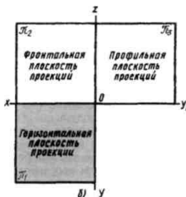
Рисунок - Для простоты проецирования плоскости располагают взаимно перпендикулярно.
